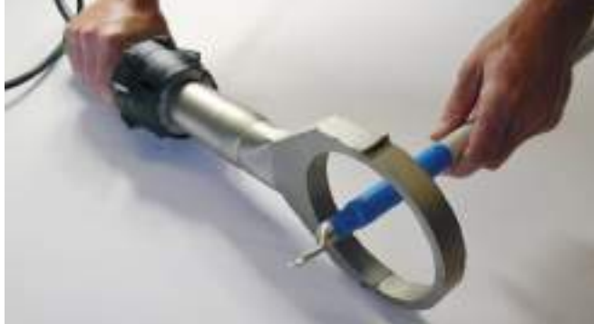
Процесс термоусадки при помощи аппарата ELECTRON ST
